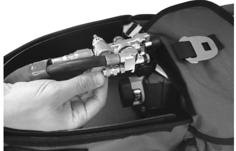
Vanne de décharge du détenteur du Kit de sauvetage RIT
