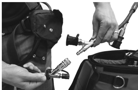
Connexion au tuyau du dispositif de respiration Copain-Copain de l'APRIA (le cas échéant)
