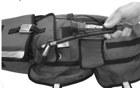
Retirez le tuyau du détendeur du Kit de sauvetage RIT
