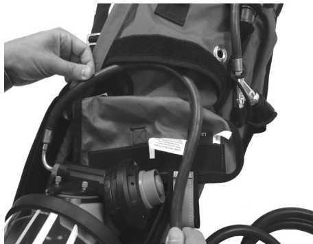
Placez le tuyau de Revitox dans la pochette
