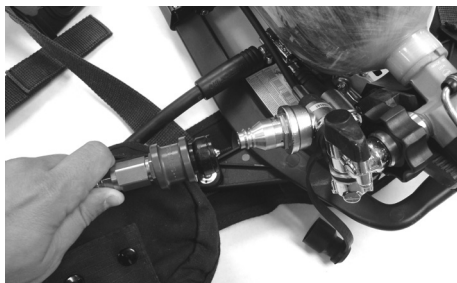
Connexion du câble de sécurité
